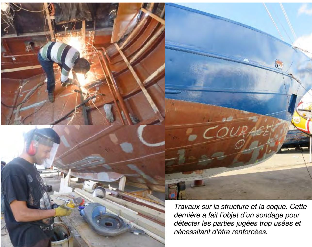
*Travaux sur la structure et la coque. Cette dernière a fait l'objet d'un sondage pour détecter les parties jugées trop usées et nécessitant d'être renforcées.*
