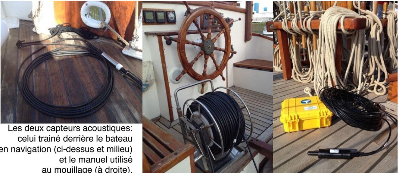
Les deux capteurs acoustiques: celui traîné derrière le bateau en navigation (ci-dessus et milieu) et le manuel utilisé au mouillage (à droite).
